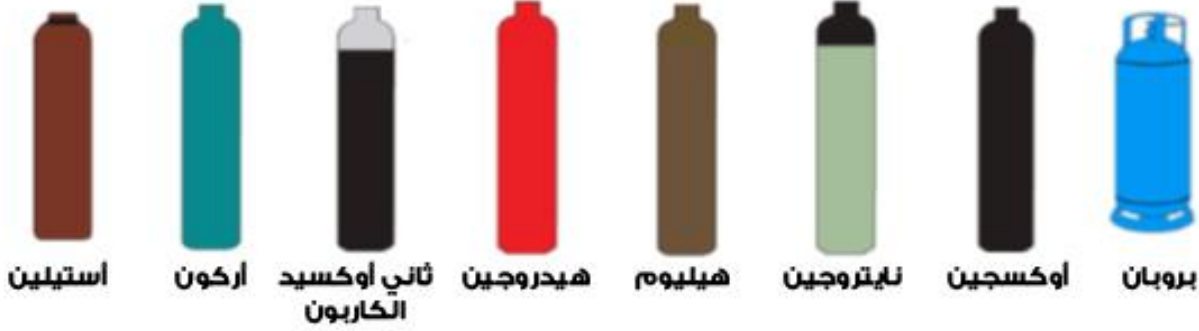
الشكل ٢ ألوان اسطوانات الغاز الصناعي
